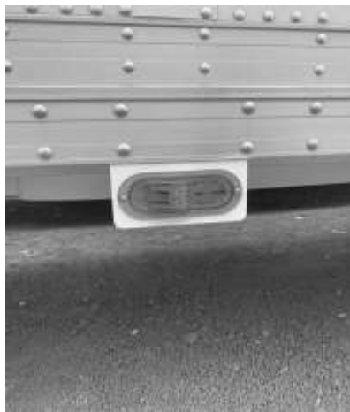
7. Inspeccione y limpie las luces de posición laterales y el material reflectante.
