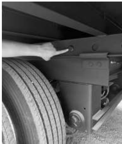
8. Cuando corresponda, inspeccione el bloqueo deslizante en tándem.
