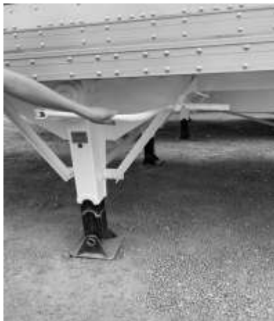
6. Asegúrese de que los patines estén levantados y que la manija esté bien guardada en el soporte de la manivela.
